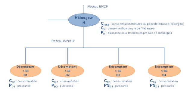
Puissance à souscrire pour l'acheminement par hébergeur : PS<sub>ach</sub> = P<sub>H</sub> + P<sub>D1</sub> + P<sub>D2</sub>
